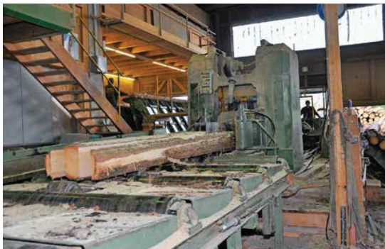
Roland Maurer schneidet Schwachholz auf der Gattersäge der Firma J. Bögli. Links und rechts fällt beim Schnitt je eine Schwarte an, die zu Holzschnitzeln verarbeitet wird.
